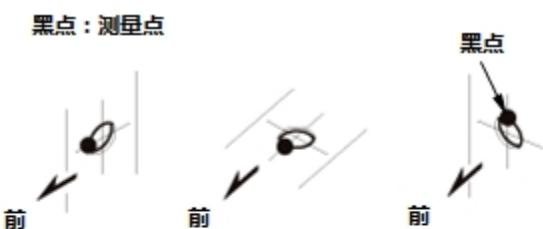
车身测量尺寸表示详图中所示的定位凸台和/或定位孔前端或上边缘之间的距离。
